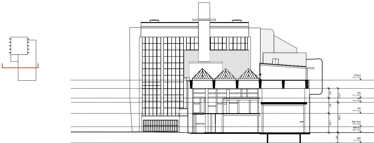
Coupe transversale "Chaufferie gaz" BB' faisant apparaître des planchers partiels
